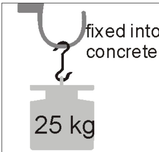
Spiralul utilizat trebuie sa fie de 8mm
