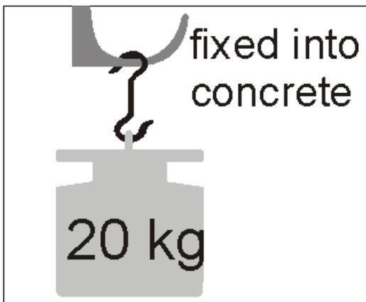
Spiralul utilizat trebuie sa fie de 6mm
