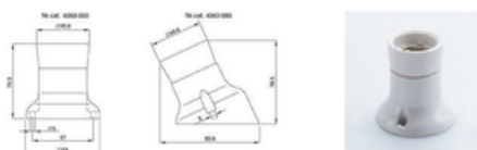
Dulie portelan tip E 27 4A, 250V cu talpa fixare
