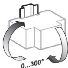
Instalare în orice poziție.
