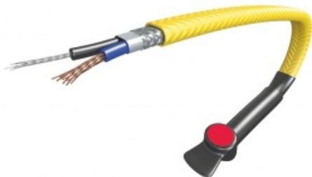
Panglica MAGNUM Ideal anti-înghet este disponibil în lungimi de 1 până la 48 de metri. Banda de incalzire este pornita la temperaturi mai mici de  $+5^{\circ}\text{C}$  și în mod automat se opreste atunci când temperatura depăsește  $+13^{\circ}\text{C}$ .
