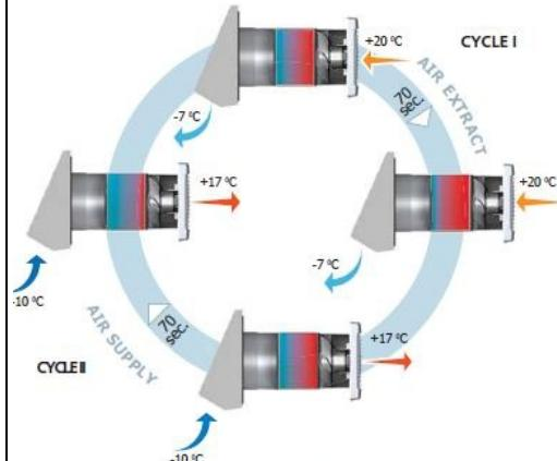
Componentele principale ale unui ventilator cu schimbator de caldura sunt: o conductă de aer telescopică cu lungime reglabilă, acumulator de caldura, unitate ventilator, placă de montare și hotă de ventilare exterioară.
